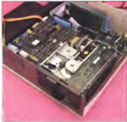
La grande unità a disco di 540 Kbyte, da 35 Kbyte con il sistema protetto, è installata nel spazio di maggior parte di slot spazio in un'unità PC. Sotto l'unità di 540 Kbyte si trova quella compatibile Apple di 145 Kbyte.
